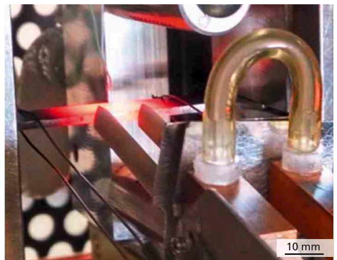
1 Versuchsaufbau am Gleeble 3150 Messsystem zur Aufnahme von Fließkurven bei Temperaturen bis 1 000 °C mit gekühltem Extensometer.
