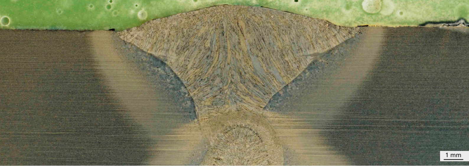
Lichtmikroskopische Aufnahme der unterschiedlichen Gefügezonen einer Schweißverbindung.
